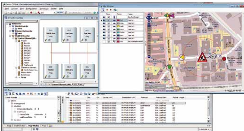
Bild 3: Das komplette Testszenario lässt sich in CANoe.C2X umsetzen und visualisieren. Übersichtliche Darstellung der ITS-Stationen im Kartenfenster mit Anzeige der Fahrtrichtung.
